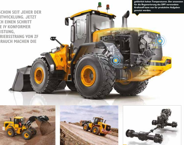
Da kein DPF benötigt wird, entfallen die hierfür erforderlichen zusätzlichen Kraftstoffleitungen und die mit der Regenerierung einhergehenden
