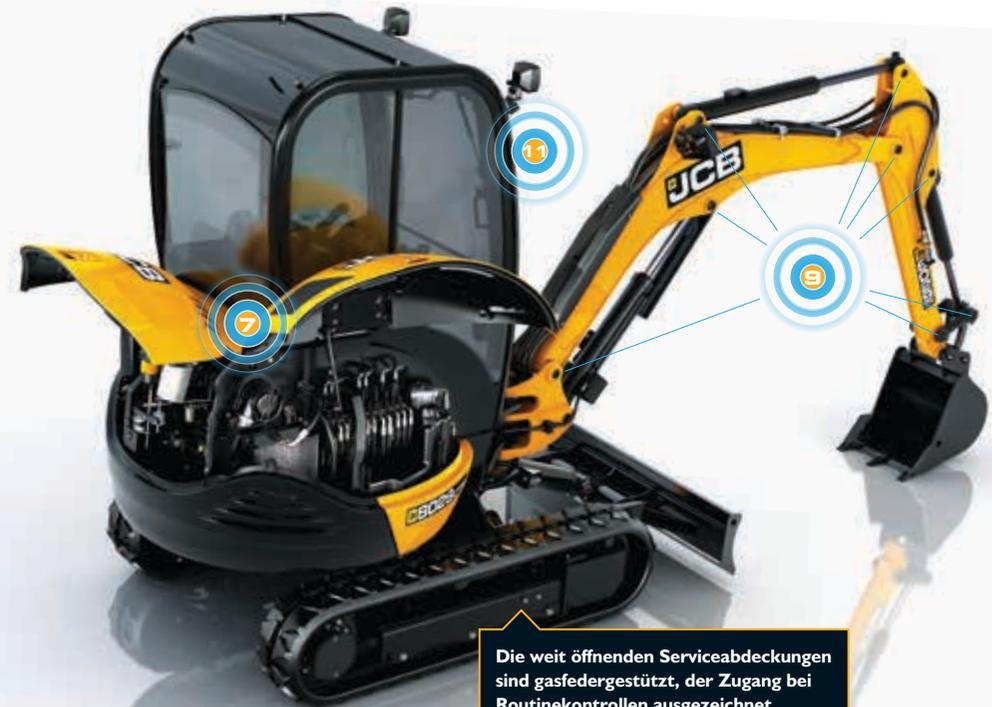
Die weit öffnenden Serviceabdeckungen sind gasfedergestützt, der Zugang bei Routinekontrollen ausgezeichnet.
