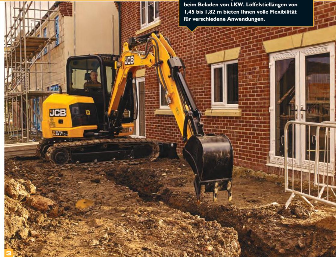
Der Löffel bietet mit einem enormen Drehwinkel von 181° einen ausgezeichneten Materialrückhalt beim Beladen von LKW. Löffelstielängen von 1,45 bis 1,82 m bieten Ihnen volle Flexibilität für verschiedene Anwendungen.
