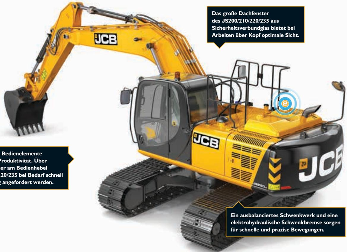
Das große Dachfenster des JS200/210/220/235 aus Sicherheitsverbundglas bietet bei Arbeiten über Kopf optimale Sicht.
