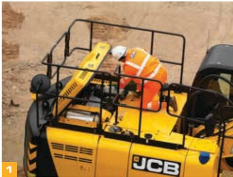
**1** Die Motorhaube des JS200/210/220/235 lässt sich für einfache und sichere Motorwartung von vorn öffnen.
