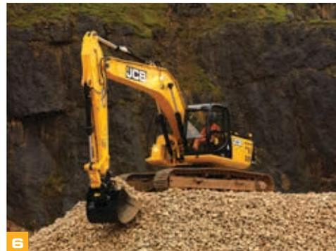
**8** JCB erfüllt ohne Dieselpartikelfilter die Abgasnorm Euro IV. Der Additivtank (Diesel Exhaust Fluid) ist auf dem Oberwagen angebracht und über die neu konzipierte Trittstufenkonstruktion leicht erreichbar.
