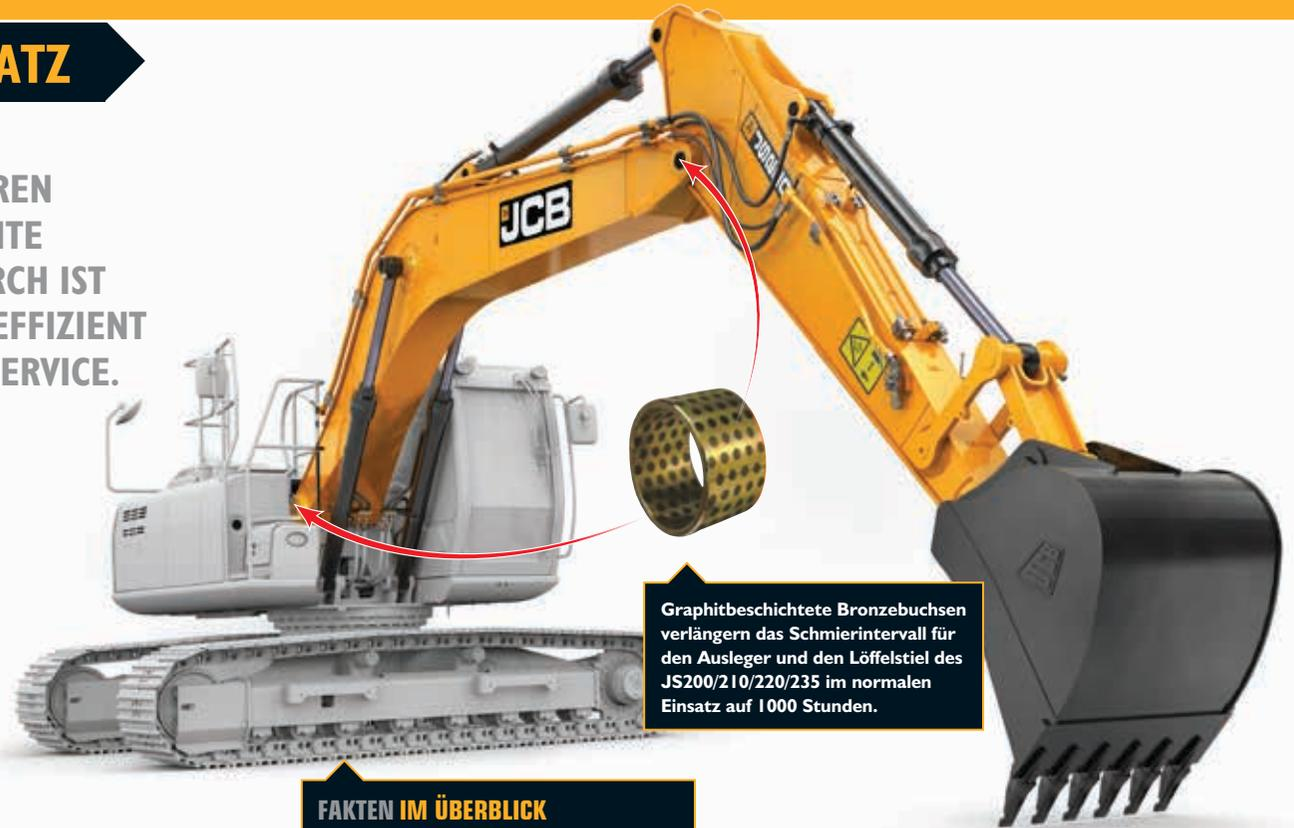
Graphitbeschichtete Bronzebuchsen verlängern das Schmierintervall für den Ausleger und den Löffelstiel des JS200/210/220/235 im normalen Einsatz auf 1000 Stunden.
